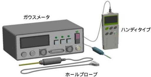
磁束密度は、ガウスメータとホールプローブのセットで測定します。ホールプローブと被測定物との密着度(あるいは間隔)や平行度など、取り決めた測定条件のバラツキを抑制するプローブスタンドなどを用い測定の精度を確保します。
