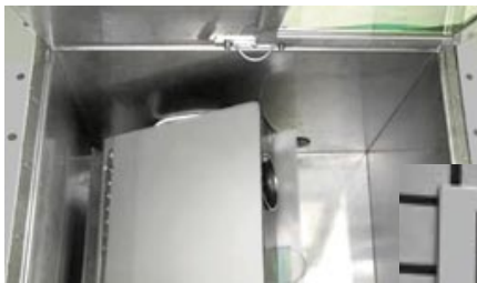
電磁波の反射に配慮した白色系材質を投影パネルに適用
