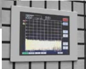
電磁波の反射に配慮した白色系材質を投影パネルに適用
