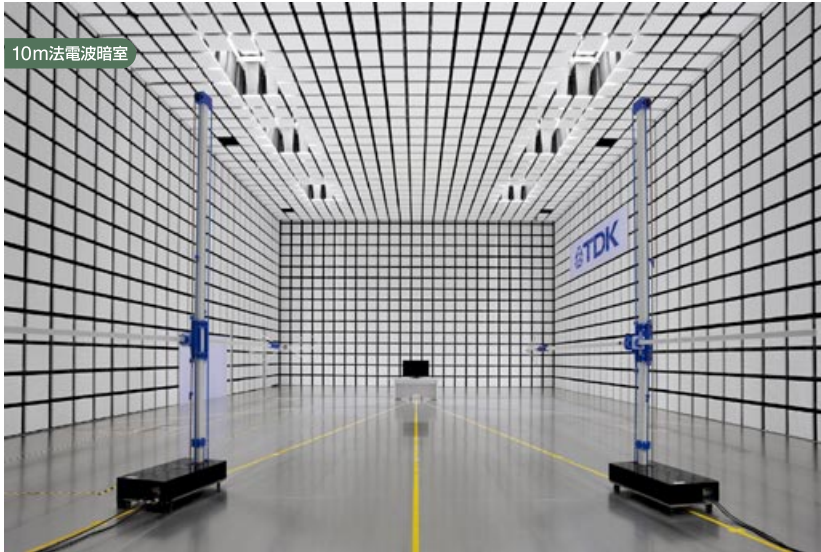
10m法電波暗室 シールド面寸法: L30×W20×H11.9m / ターンテーブル: 3m (1 ton) / 6m (4 ton) Dual サイトアッテネーション: 30MHz to 1GHz ± 1.5dB以内 ( 6m領域)
