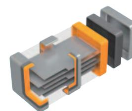
チップ内部を直流電流が通る貫通型構造
