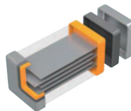
内部電極は端子電極間で導通していない
