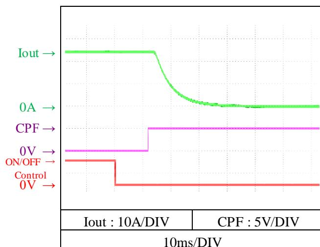
(a) リモートON/OFFコントロール端子によるON/OFF
