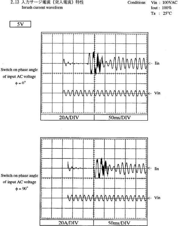
2.13 入力サージ電流 (突入電流) 特性
