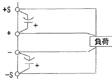
+S端子/+端子、-S端子/-端子のショート板を取り外し、
