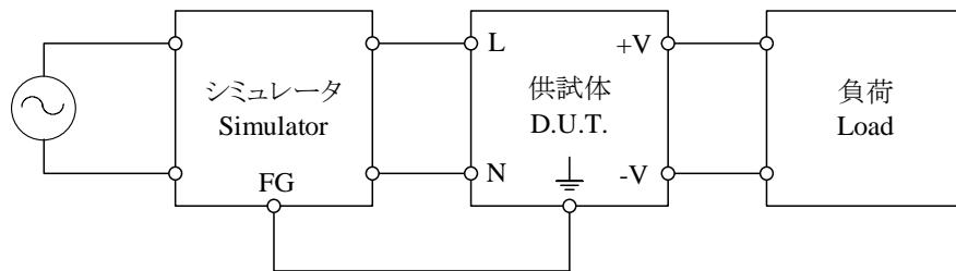
シミュレータ : INS-AX2-450TH (ノイズ研究所)
