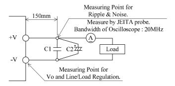
C1 : Film Cap.  $0.1\mu F$ C2 : Elect. Cap.  $47\mu F$
