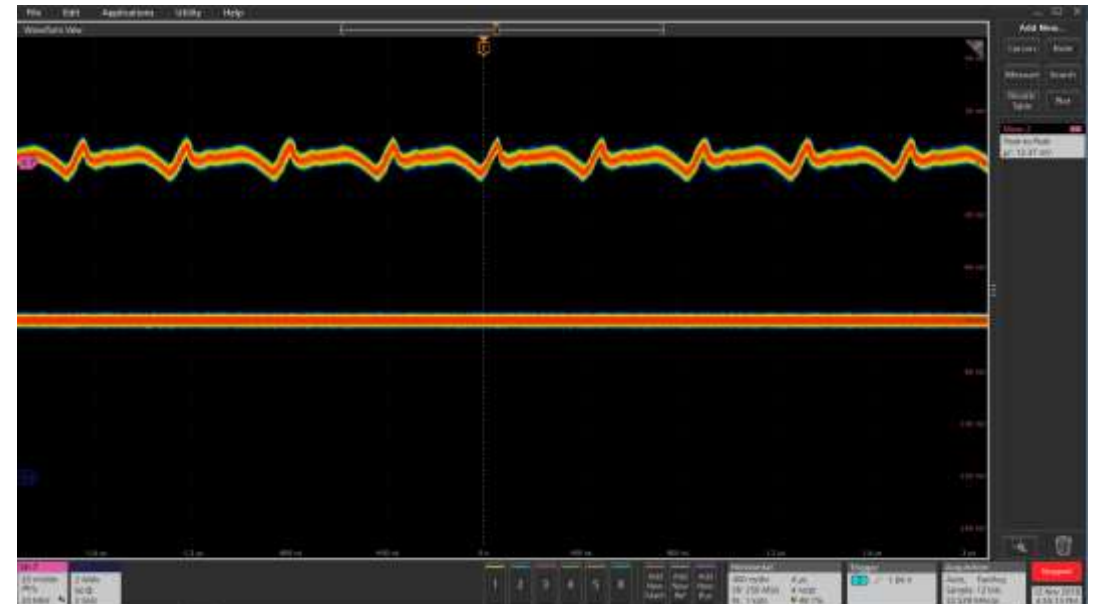
Vo ripple 12.4 mV @ 6 A Ch7: Vo CH6: Io
