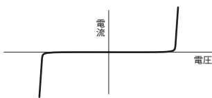
図8-37 バリスタの電圧・電流特性
